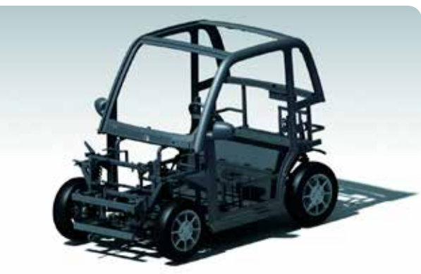
Dubbele kreukelzone met rolkooi
